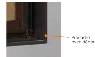
Le précadre possède un débord sur les 4 côtés permettant une parfaite finition sur le coffrage. Celui-ci peut varier de 1,5 cm à 3 cm.
