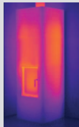
12 hod. od zatopení Průměrná teplota povrchu 45 °C
